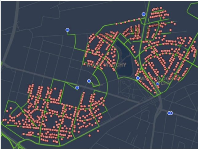
Rysunek 6. Przykładowe połączenia światłowodowe w modelu, w którym połączenia (zielone linie) prowadzone są wzdłuż dróg*
